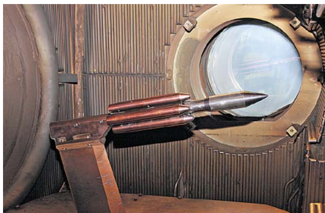
Исследование аэродинамического нагрева моделей тяжёлой многоблочной ракеты-носителя «Ангара-5»
