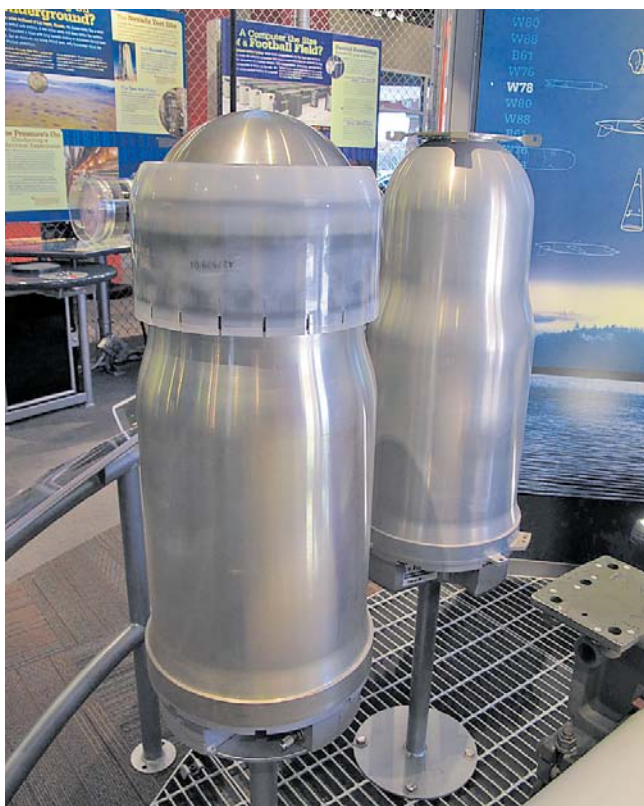
W-84 боеголовка ракеты BGM-109 G — для наземной версии «Томагавка» (слева), W-80 — для морской версии «Томагавка» UGM-109A (справа)
