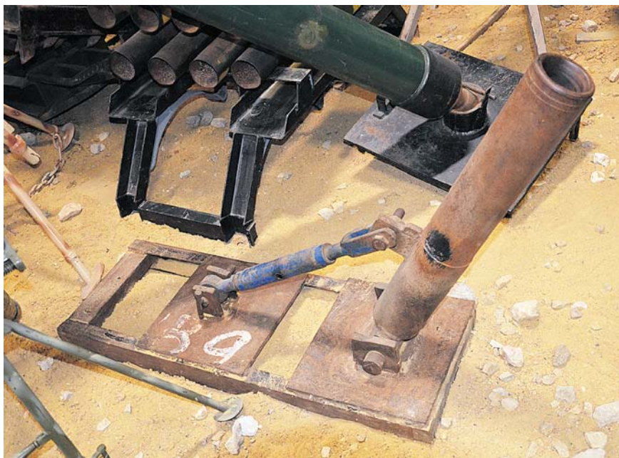
Гладкоствольный миномёт сирийских повстанцев, созданный по глухой схеме. 2016 год. (Фото А. Широкограда)
