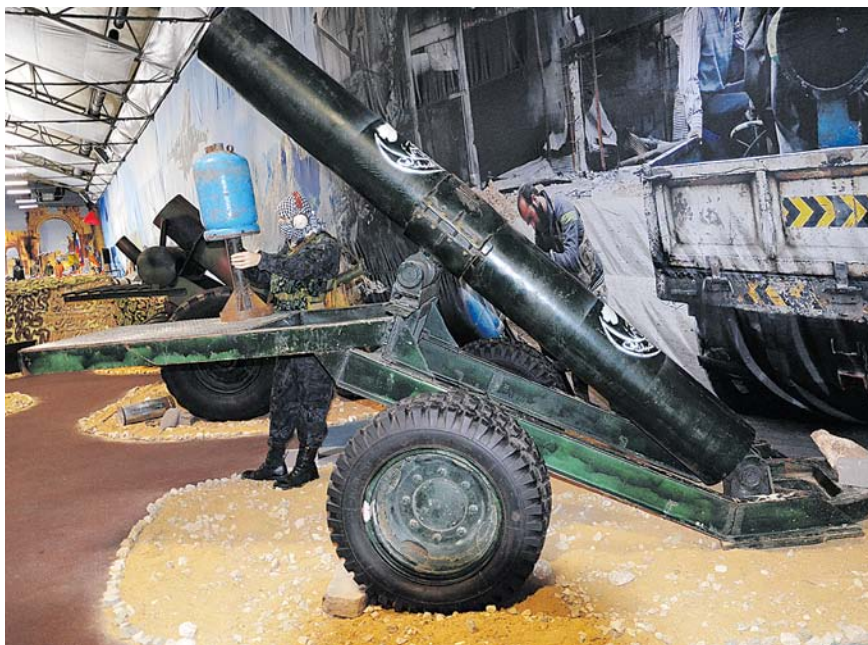
305-мм гладкоствольный миномёт сирийских повстанцев, созданный по схеме реального треугольника. Вид сбоку. (Фото А. Широкограда)
