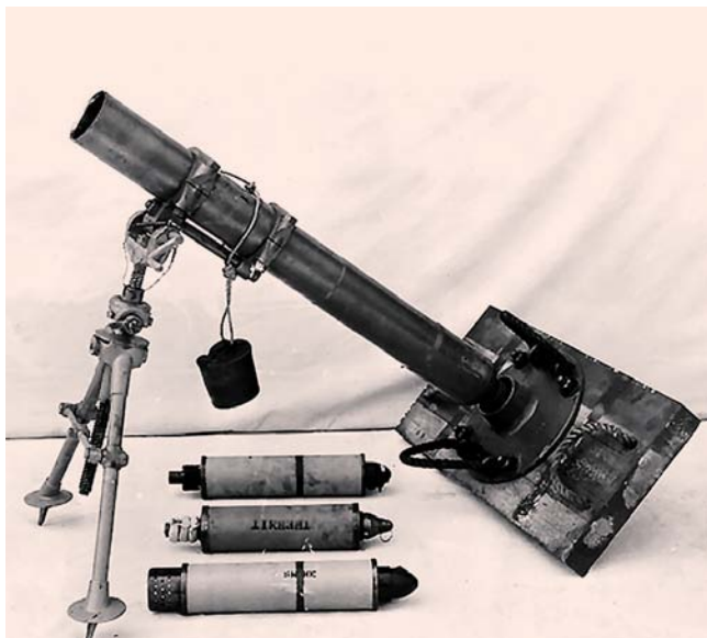
81,2-мм «революционный» миномёт Стокса, созданный в 1917 г. по схеме мнимого треугольника
