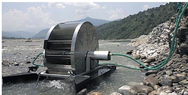
Бесплотинная мини-ГЭС (в данном случае нижнебойное колесо)
