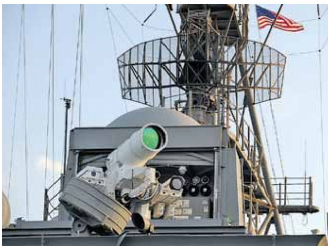
Лазерная боевая система LaWS, установленная на корабле AFSB(I)-15 «Ронсе» (ноябрь 2014 года)
