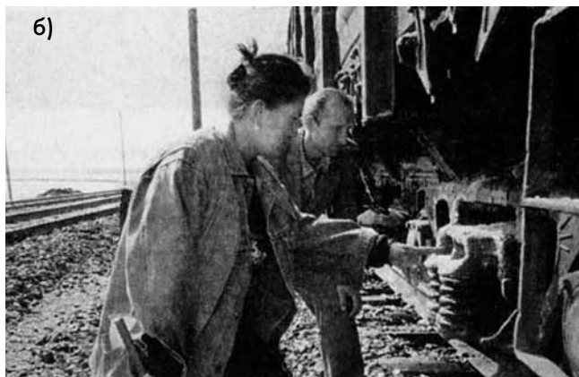
Рис. 3. Отложения соли на сваях в озере Баскунчак — а) и на вагонах — б)
