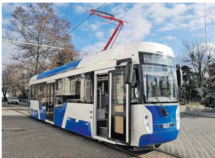
Посадка пассажиров осуществляется через три прислонно-сдвижные двери: две одностворчатые на свесах и двухстворчатую в середине.
