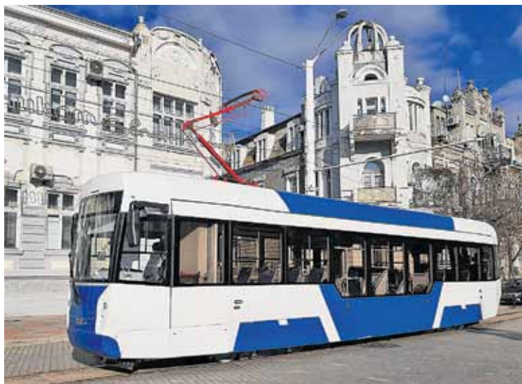
Все «технические» агрегаты трамвая — крышное электрооборудование, тележки, сцепные устройства — закрыты фальшбортами. Фото пресс-службы ОАО «Уралтрансмаш» http://www.uraltransmash.com/
