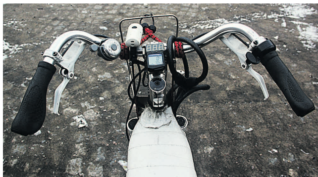
На руле находятся велокомпьютер, индикатор заряда АКБ и звуковой сигнал
