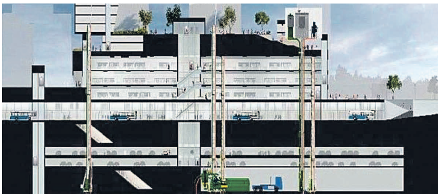
Рис. 10. Система сбора твёрдых отходов в торговом центре Триппа, район Хельсинки Пасила, Финляндия. https://futureenviro.es/en/marimatic-builds-a-solid-waste-collection-...
