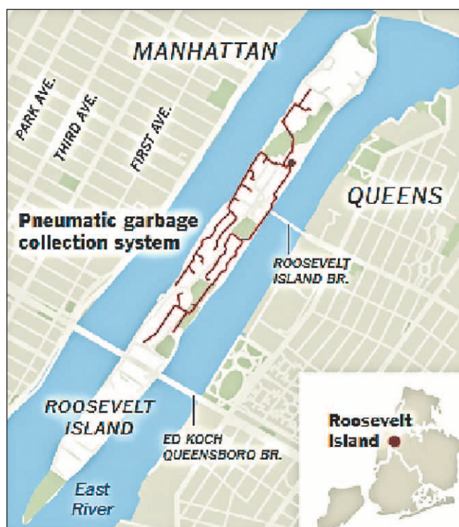
Рис. 1. Схема пневматической системы транспортировки мусора на острове Рузвельта. https://www.nytimes.com/2015/08/04/nyregion/garbage-collection-without-the-noise-or-the-... pneumatic garbage collection system — пневматическая система сбора мусора
