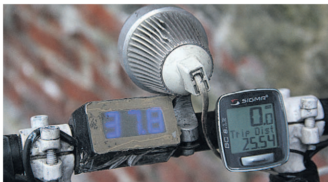
Электроника следит за «топливным баком», а компьютер выдаёт данные о поездке
