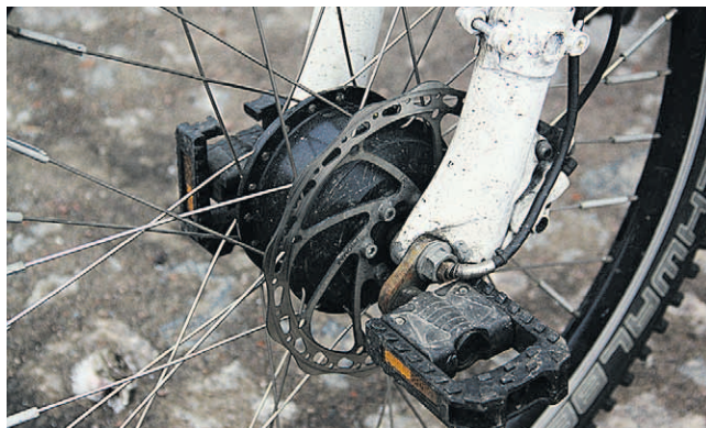
Электромотор в переднем колесе делает велосипед полноприводным
