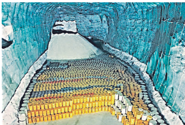
Рис. 13. Хранение опасных отходов в закрытой соляной шахте. https://fopnews.wordpress.com/2010/02/24/containing-uncertainty-design-for-infinite-...
