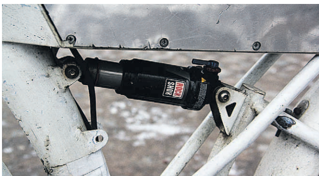
Электровелосипед 2x2 имеет подвеску обоих колёс, сзади — моноамортизатор
