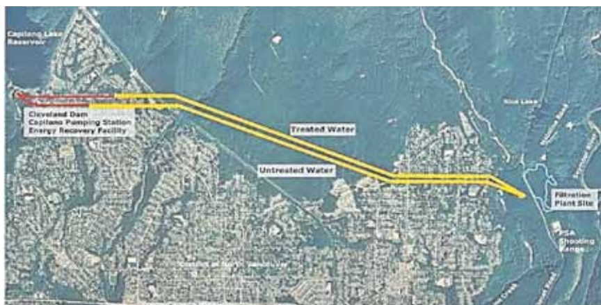
Рис. 6. План туннелей водоснабжения.
