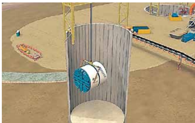
Рис. 15. Схема спуска буровой туннельной машины в ствол доступа. https://californiawaterfix.com/
