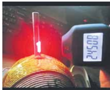
Тест скорости HELV второго поколения раскрутили до 24 500 об/мин
