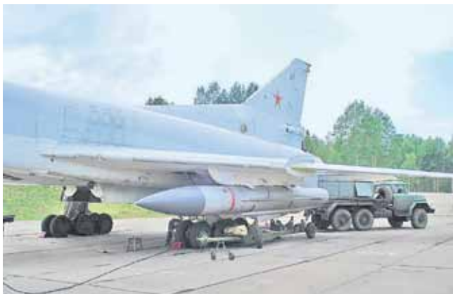
Подвеска ракеты Х-22Н на держатель БД-45К самолёта Ту-22М3
