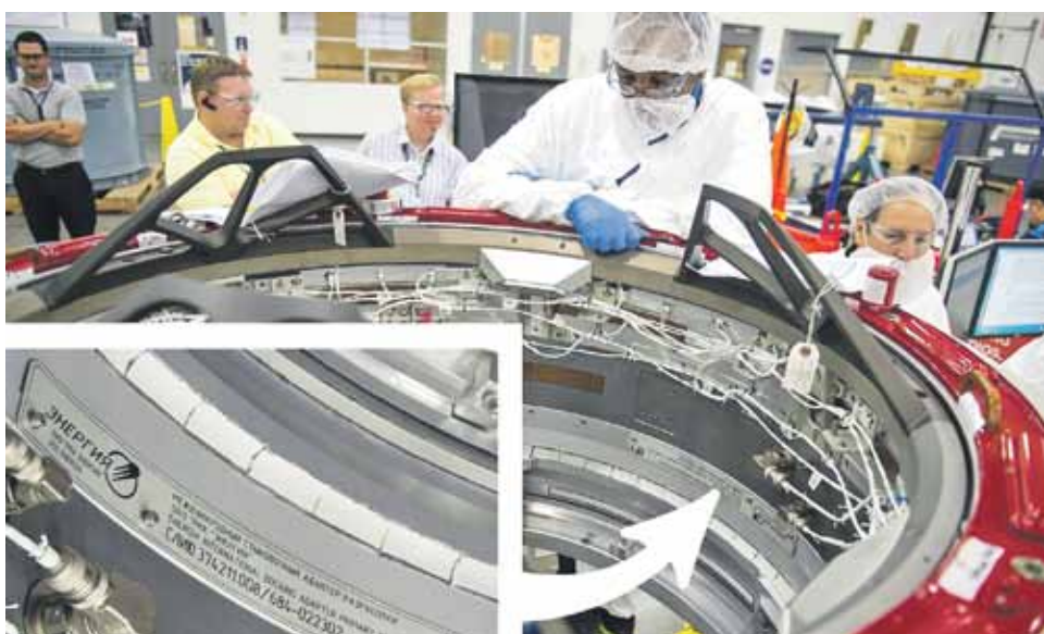
Андрогинный стыковочный агрегат корабля «Старлайнер» разработки российской РКК Энергия
