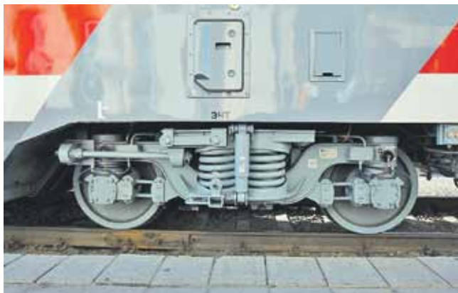
Безлюлочная тележка Тверского завода рассчитана на скорость до 160 км/ч
