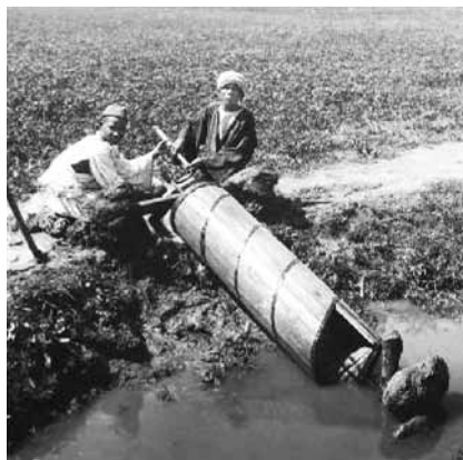
е) Подъём воды Архимедовым винтом (шнеком) в древнем Египте. http://www.waterencyclopedia.com/Po-Re/Pumps-Traditional.html
