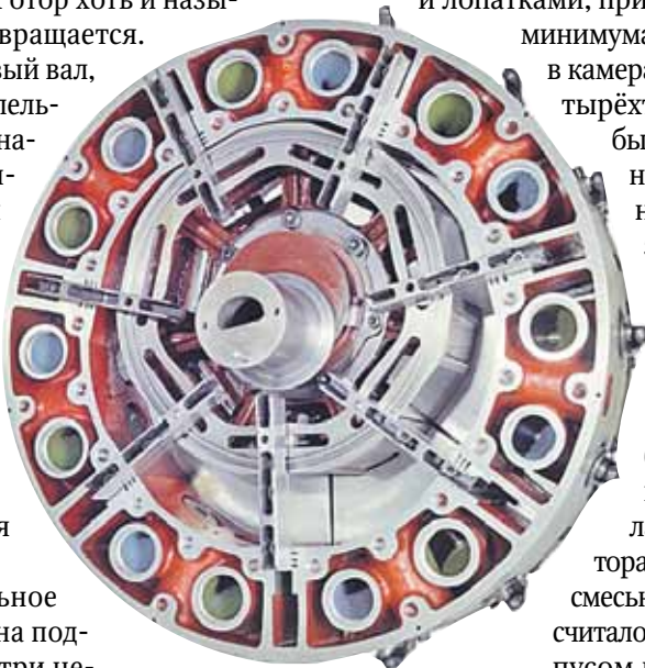
Орбитальный двигатель со снятой крышкой корпуса
