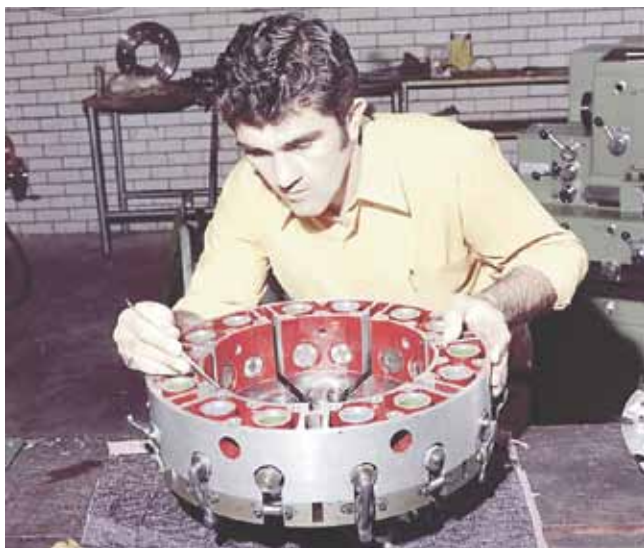
Ральф Сарич лично собирает свой мотор. Хорошо видны эксцентрики ротора и коромысла привода клапанов
