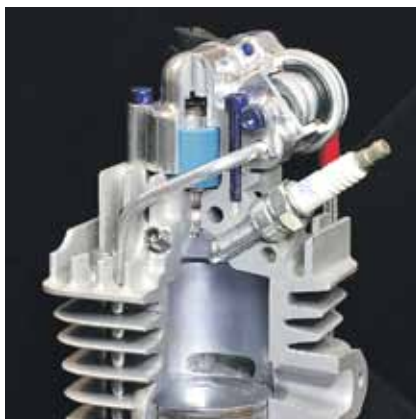
Система впрыска Orbital для двухтактного двигателя
