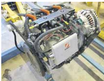
Трёхцилиндровый двухтактник с системой управления Orbital
