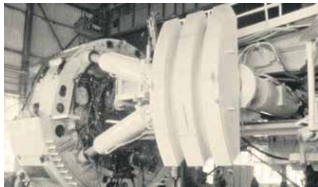
Рис. 11. Распорные домкраты буровой туннельной машины проекта TARP
