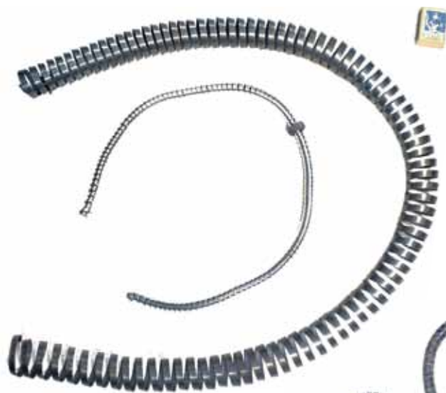
Рис. 4. Стружка сливная, полученная при обтачивании железнодорожного колеса и вала; на стружку, снятую с вала, навинчена гайка. Масштаб — спичечный коробок
