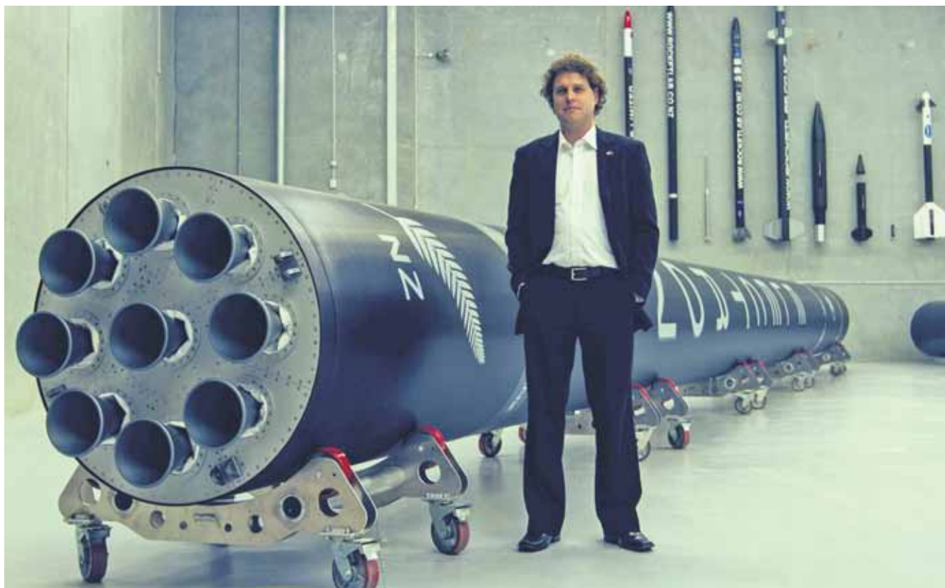
Rocket Lab представляет углекомполитную ракету-носитель Electron с первыми в мире, напечатанными на 3d-принтере, двигателями Rutherford, снабжёнными электроприводом топливных насосов
