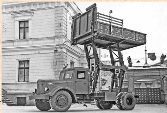
Аэродромный автоподъемник АПК-6х4,5 рижского завода № 85 ГА. 1960 г.
