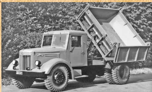
Опытный МАЗ-506 с боковым опрокидыванием кузова. Минск, 1955 г.
