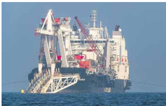
Судно Audacia компании Allseas во время укладки труб на германском участке газопровода Северный поток-2
