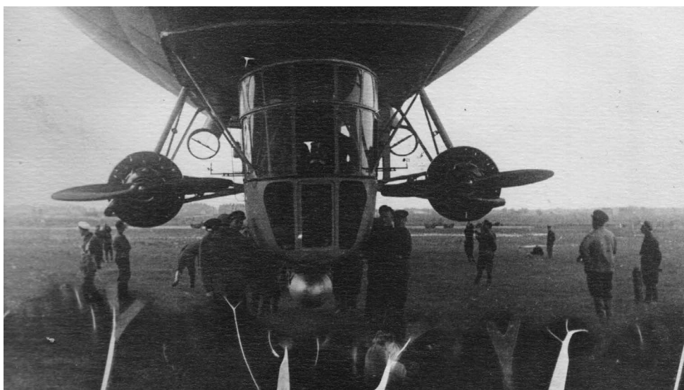
За мотогондолами видны правая и левая огневые точки с пулемётами ШКАС
