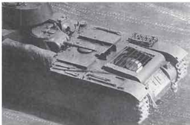
Двигатель и трансмиссия в корме, на броне инструмент, зенитного пулемёта нет
