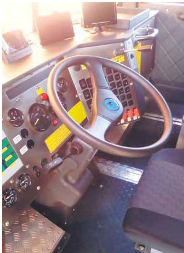
На приборной панели появились электронные дисплеи с указателями температур масла и охлаждающей жидкости
