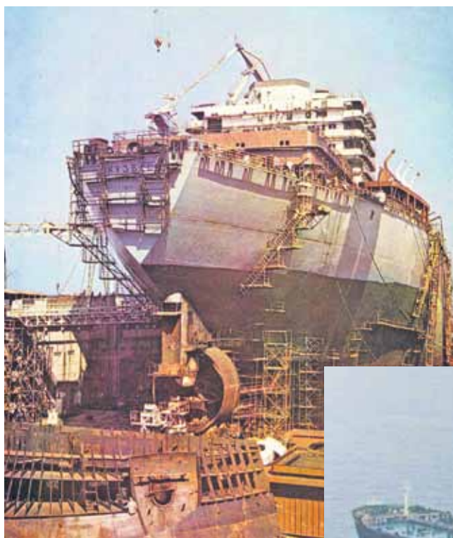
Танкер «Кузбасс» проекта 1511 в процессе постройки, видна направляющая насадка винта
