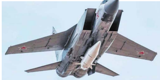
Авиационный ракетный комплекс «Кинжал». На внешней подвеске истребителя МиГ-31БМ закреплена ракета Х-47М2
