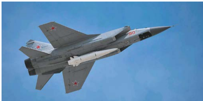
Авиационный ракетный комплекс «Кинжал». На внешней подвеске истребителя МиГ-31БМ закреплена ракета Х-47М2
