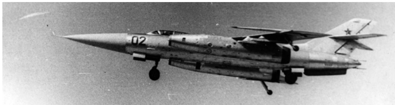
Перехватчик Як-28П – носитель двух ракет средней дальности Р-8 или Р-98 и двух ближних Р-3С
