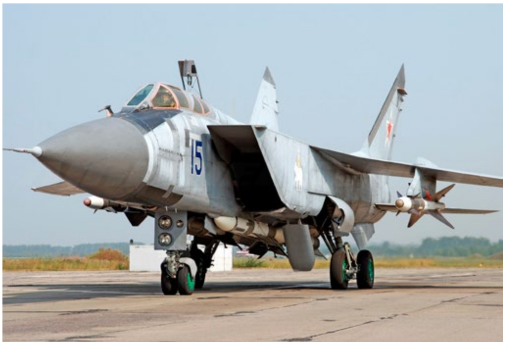
Перехватчик дальнего действия МиГ-31 с ракетами большой дальности Р-33 под фюзеляжем и средней дальности Р-40ТД под крылом
