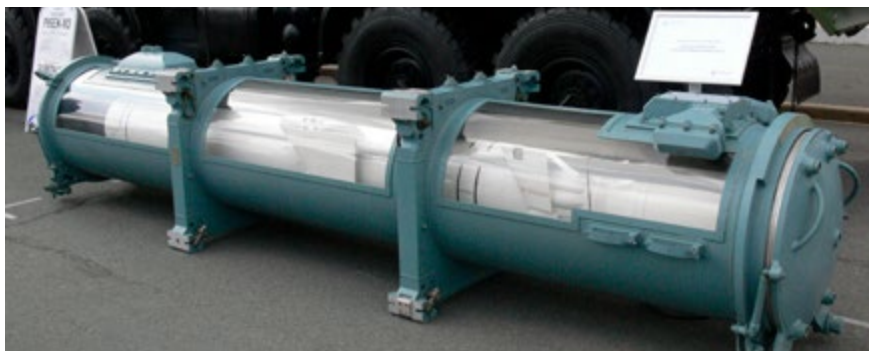
Транспортно-пусковой контейнер с ракетой X-353
