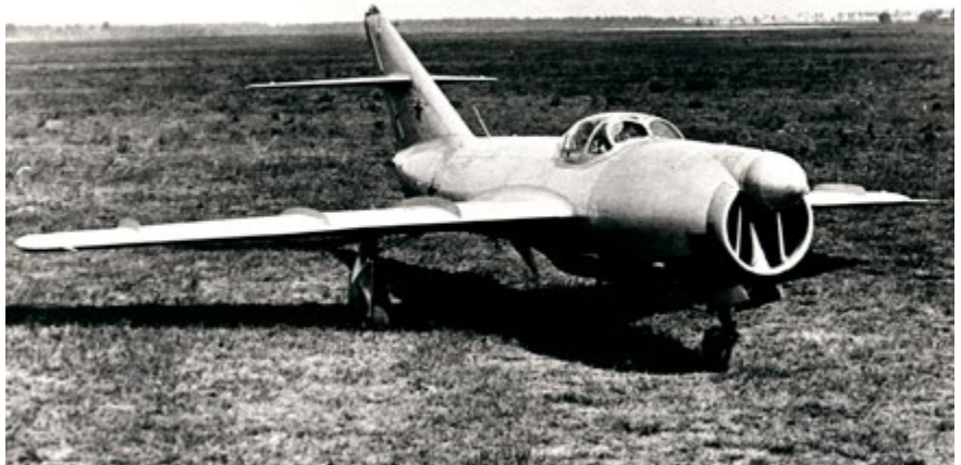
Опытный всепогодный барражирующий перехватчик И-320 конструкции ОКБ-155 Микояна и Гуревича
