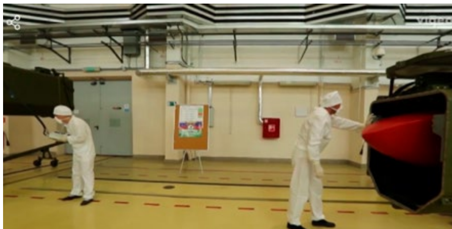
Нижний проём в транспортном контейнере сделан для того, чтобы там поместился воздухозаборник ЯТРД. Специалисты работают в масках
