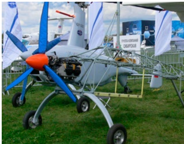
Каркас беспилотного автожира DY-500
