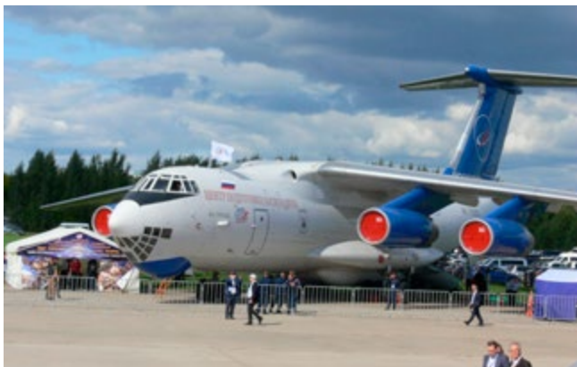
Ил-76МДК, предназначенный для тренировки космонавтов на невесомость
