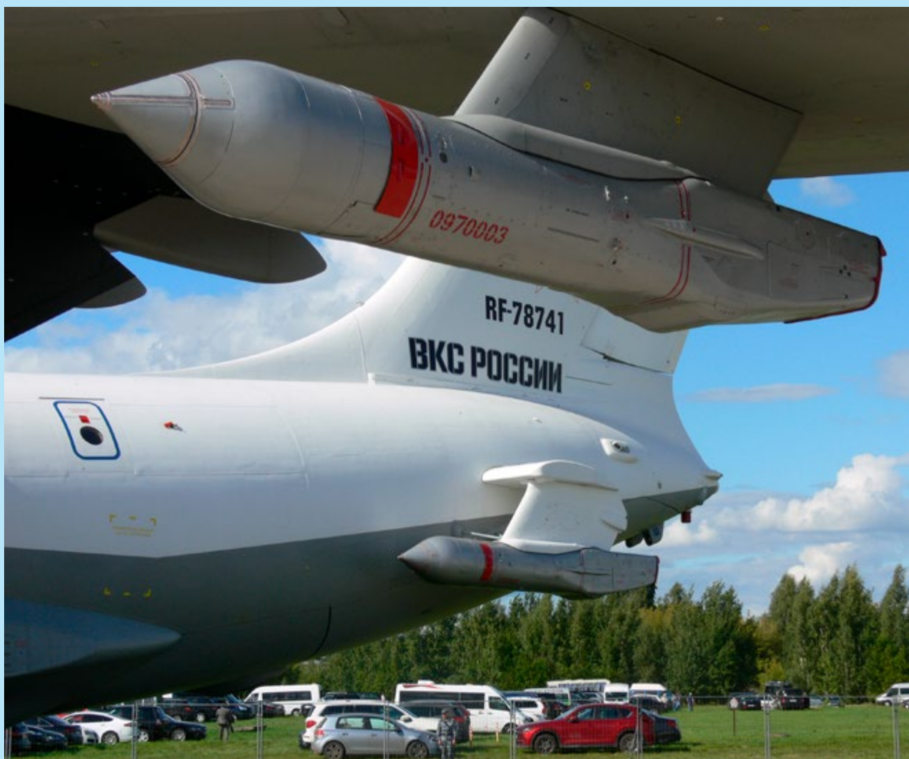
Агрегаты заправки (под крылом и на фюзеляже) самолёта Ил-78М
