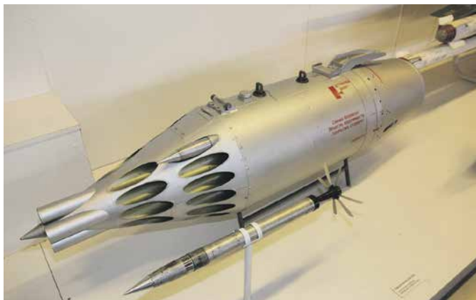
Пусковой блок УБ-32-57 для С-5 рассчитан на 32 ракеты
