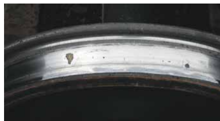
Дефекты на круге катания колеса тоже снижают ресурс буксы
