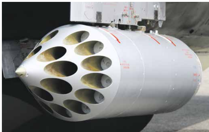
Пусковой блок Б-8 для ракет С-8 вмещает 20 ракет
