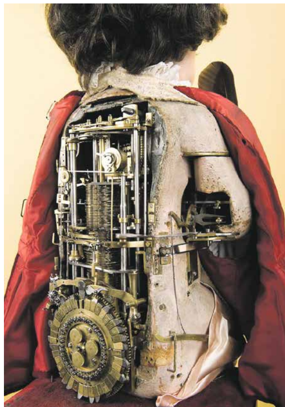
Очень «жёсткий диск» образца XVIII века. С помощью такого механического наборного устройства Пьер Жак Дро программировал работу своего «мальчика-каллиграфа»
