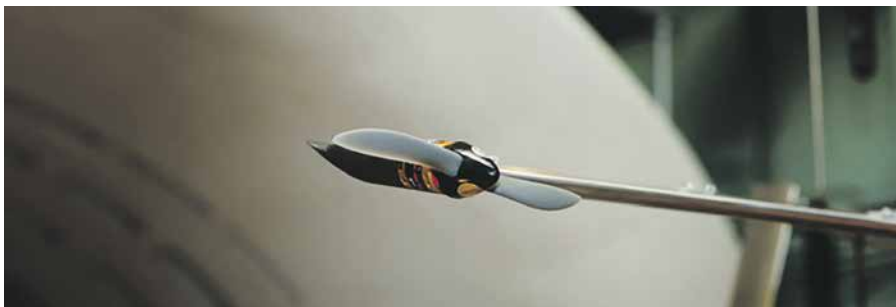
Левая мотогондола с двигателем, закреплённая на законцовке крыла модели-демонстратора
