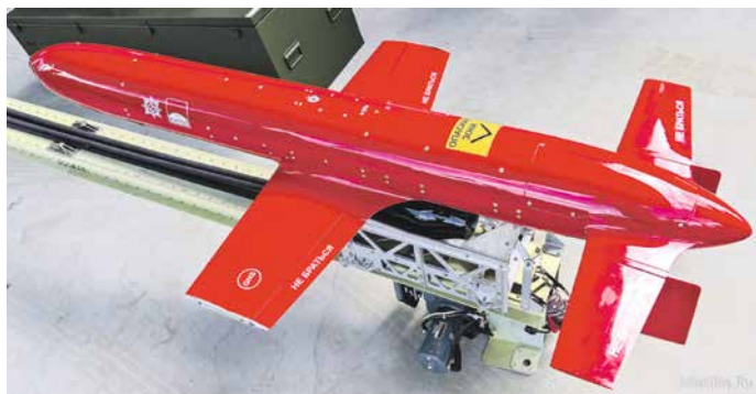
Воздушная мишень ракетного типа с ТРД (МВ-Р) для учебного мишенно-тренировочного комплекса «Адьютант»
