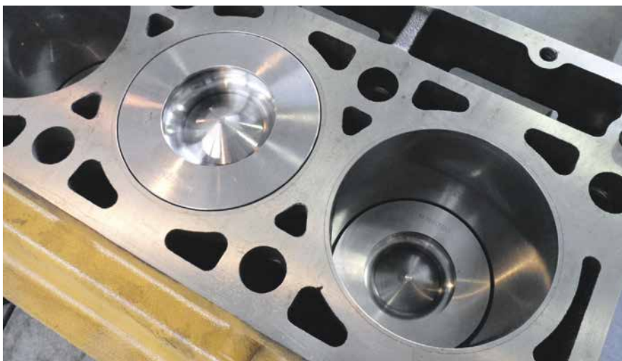
Блок цилиндров современного дизеля с камерами сгорания в поршне
