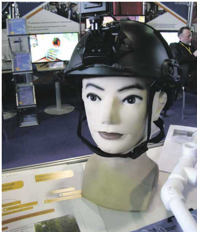
Шлем беспроводного портативного комплекса аудиовидеосвязи
