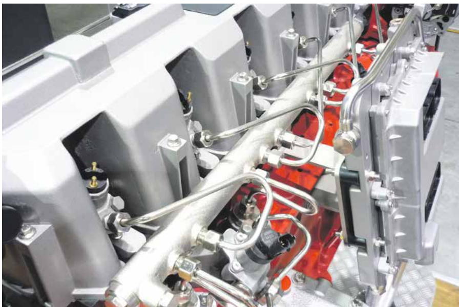
Топливный резервуар Common Rail с трубопроводами и форсунками
