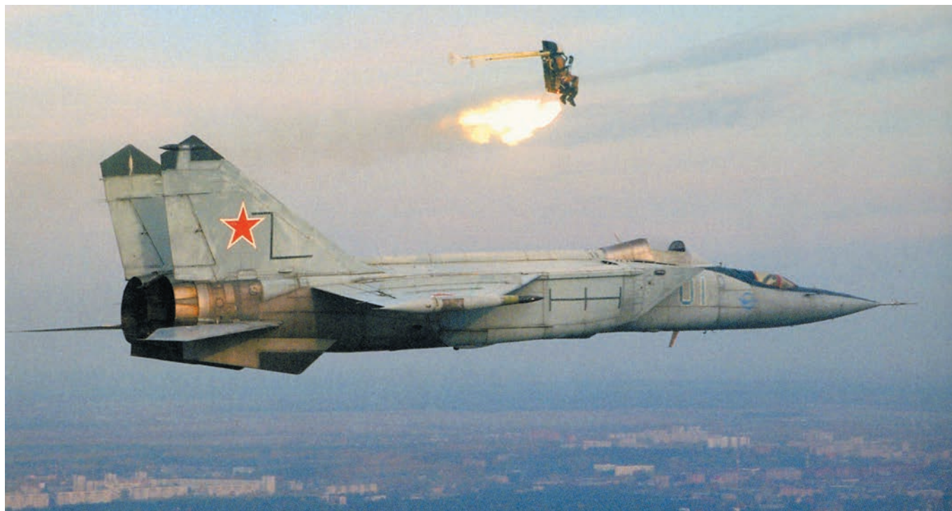
Катапультирование кресла К-36Д-3,5 из летающей лаборатории МиГ-25
