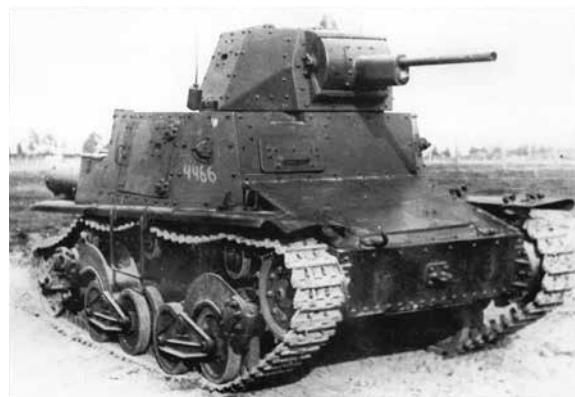
Итальянский лёгкий танк L6/40, принятый на вооружение уже после начала Второй мировой войны. Он, конечно, превосходил Т-26 (в незкранированном варианте) по толщине лобовой и башенной брони, но ведь и разработан был намного позднее. Кстати, уже после капитуляции Италии производство L6/40 продолжалось на оккупированной немцами территории – для вермахта
