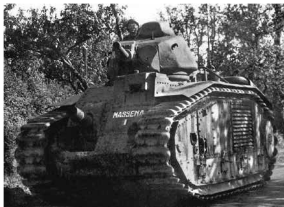
Французский средний танк B1 bis. Хотя он не относился к числу «многоглавых монстров», но имел вооружение, установленное в два яруса: 47-мм орудие в башне и 75-мм – в корпусе. Немцы, захватившие немало машин этого типа, считали «нижнюю» пушку практически бесполезной
