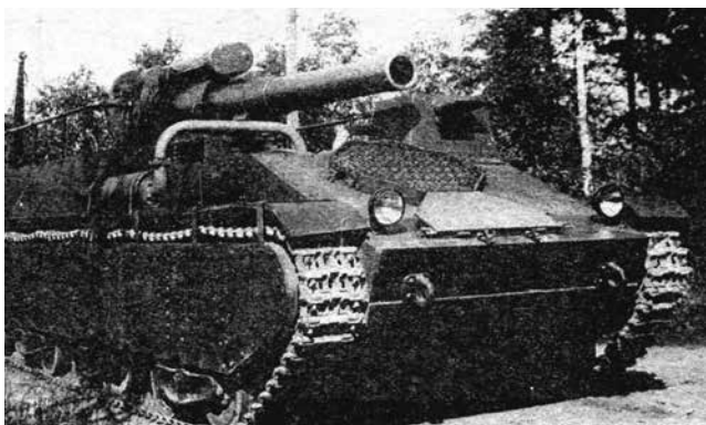
Самоходная 203,2-мм гаубица СУ-14, доработанный вариант. В 1930-е годы было разработано немало образцов САУ с использованием шасси (или элементов шасси) среднего танка Т-28 или тяжёлого Т-35. Ни одна из этих самоходов так и не пошла в серийное производство, но вовсе не из-за «принципиальной» непригодности шасси – хватало и других причин
