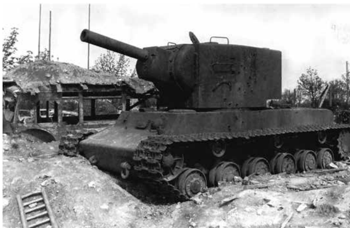
Советские военные и конструкторы вместо развития линии самоходно-артиллерийских установок пошли по пути создания артиллерийских танков, чьи орудия заметно превосходили по калибру пушки линейных машин. На фотографии – захваченный немцами KV-2, вооружённый 152-мм орудием (использовался в боях за город Эссен)
