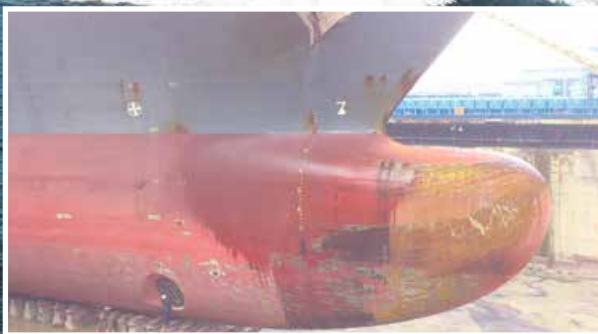
Носовой бульб снижает сопротивление
