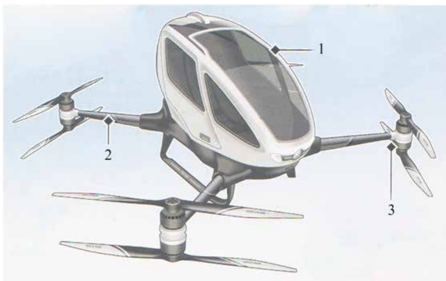
Рис. 1. Беспилотное азротакси. 1 – кабина, 2 – выдвижные стойки, 3 – электроприводы винтов
