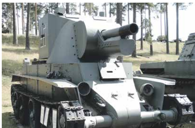
ВТ-42 – финская САУ на базе советского лёгкого танка БТ-7. Вместо башни с 45-мм пушкой на самоходке установлена британская 114-мм (4,5-дюймовая) гаубица. Единственный сохранившийся до настоящего времени экземпляр этой боевой машины находится в музее в Парола
