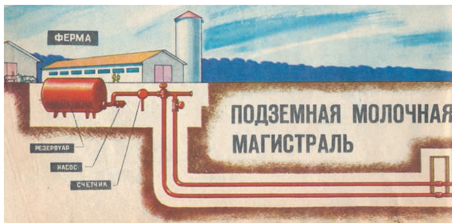
Рис. 7. Подземная молочная магистраль. 1 — резервуар; 2 — насос; 3 — счётчик
