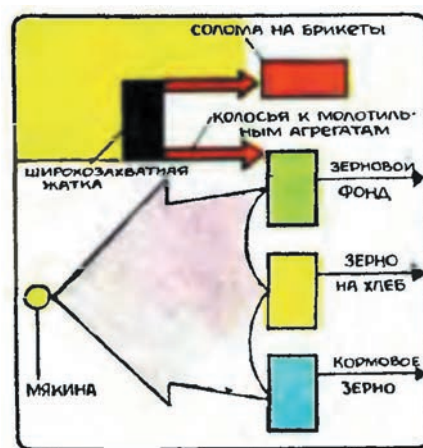
Рис. 9. Технологическая схема уборки злаковых, предлагаемая К. А. Бориным
