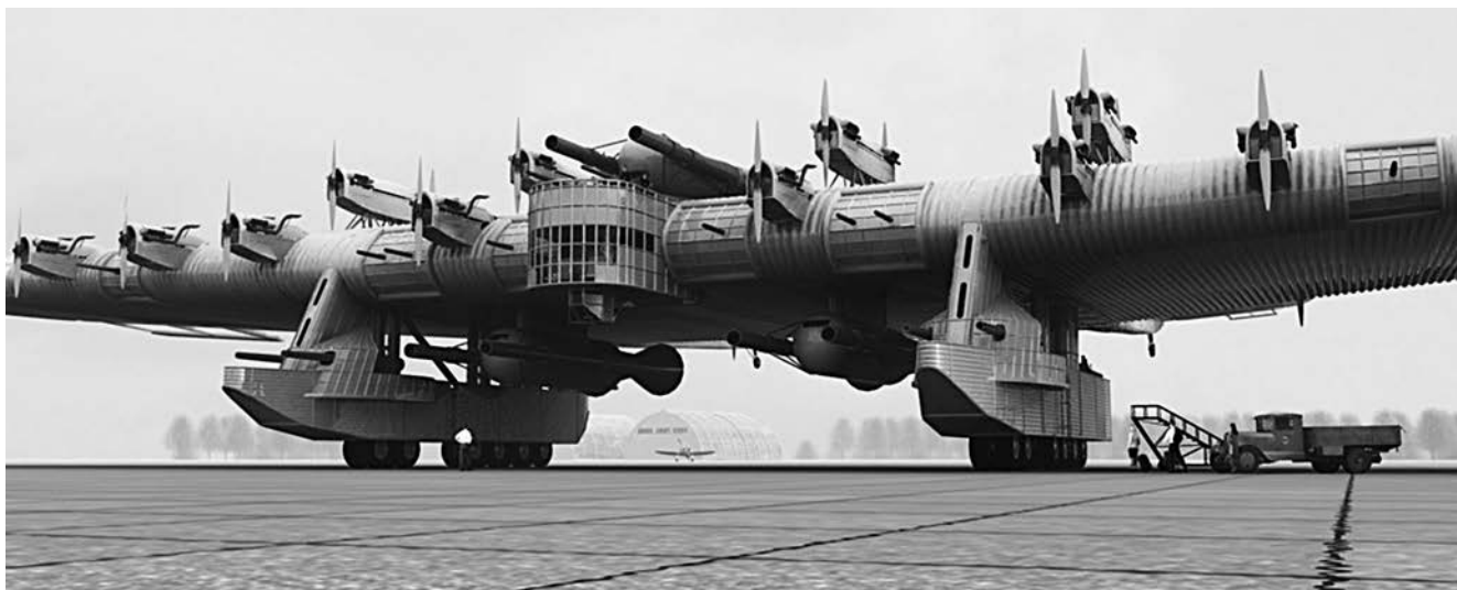
Бомбардировщик К-7, вооружённый шестью 305-мм ДРП (не совсем точная компьютерная графика)
