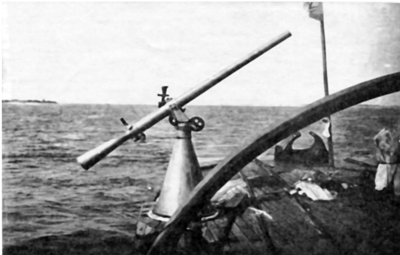
Испытания 76-мм катерной пушки Курчевского КПК на тральщике
