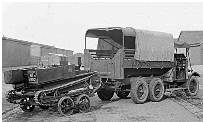
Перевозка танкетки «Карден-Ллойд» Mk.VI на подкатной тележке
