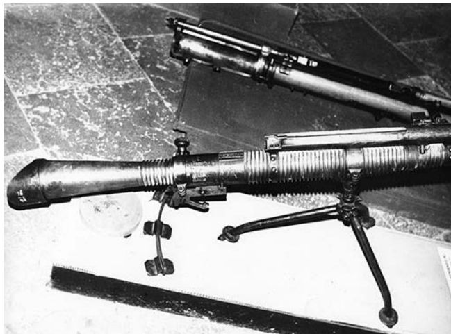
37-мм ружьё Курчевского большой мощности (сопло)
