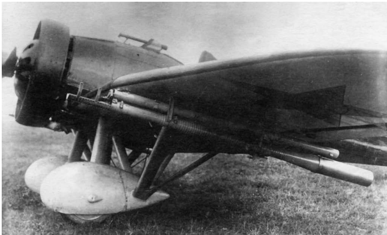
Серийный истребитель И-16 с пушками АПК
