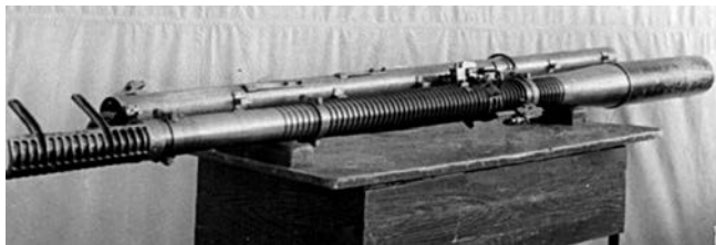
100-мм авиационная автоматическая пушка Курчевского
