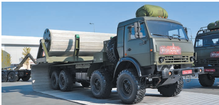
Дорогоукладчик (КРВД) — многоцелевой механизированный комплект для оперативного развёртывания временных дорог, а также для пропуска колёсной и гусеничной техники на труднопроходимых и заболоченных участках на базе КамАЗ-63501
