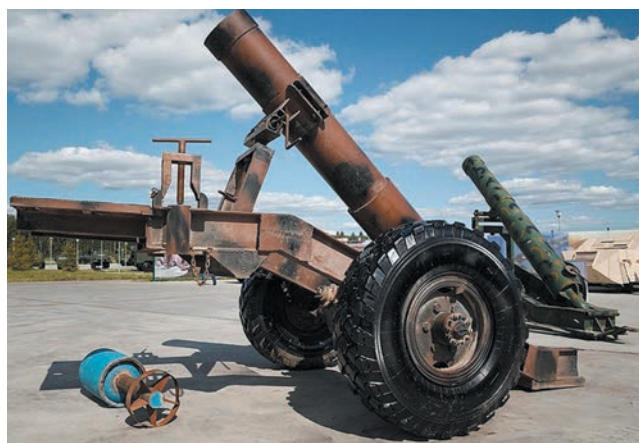
Самодельные миномёты, захваченные у боевиков в Сирии, сделаны на основе водопроводных труб
