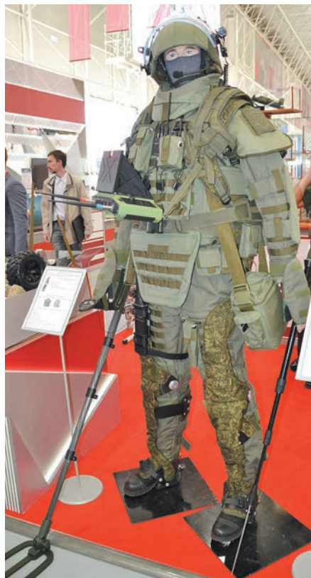
Экипировка и пассивный на вид экзоскелет для оснащения групп разминирования инженерных подразделений сделан из углепластика и весит всего 9,5 кг. В общей комплект входят костюм с переносным селективным индукционным миноискателем и рюкзак сапёра-штурмовика
