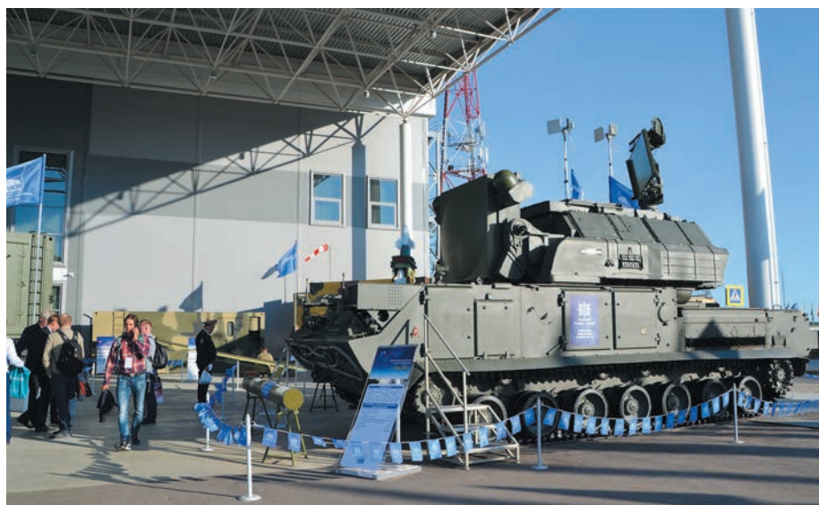
На башне «Тор-М2» видна новая антенна обнаружителя. Отличительная особенность комплекса — защита техники на марше, возможность вести огонь на ходу без остановок. По сравнению с предыдущими версиями ЗРК у нового комплекса вдвое (до 16 ракет) увеличен боекомплект, а ракеты обладают расширенной зоной поражения и повышенной точностью стрельбы
