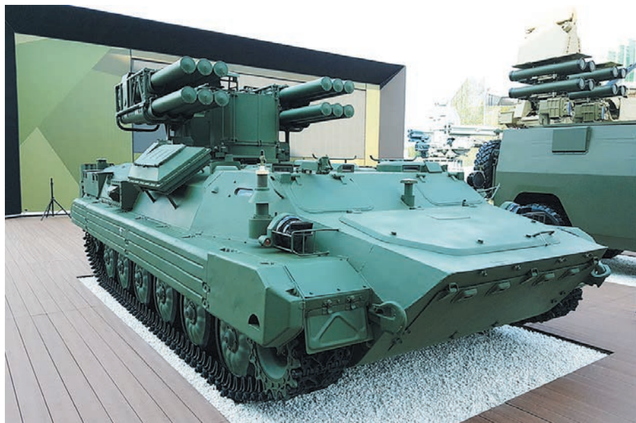
Новейший зенитный ракетный комплекс «Сосна» в ближайшее время поступит на вооружение в российскую армию. На международном военно-техническом форуме «Армия-2018» его продемонстрировали впервые. Комплекс смонтировали на базе шасси гусеничного бронетранспортёра МТ-Л
