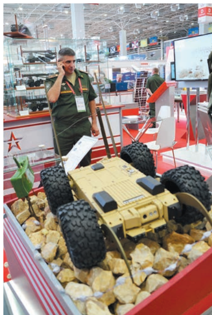
«Скорпион» — переносной малогабаритный дистанционно управляемый робототехнический комплекс разведки и разминирования
