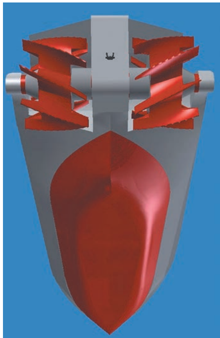
Форма корпуса ледофреза, вид с кормы...
