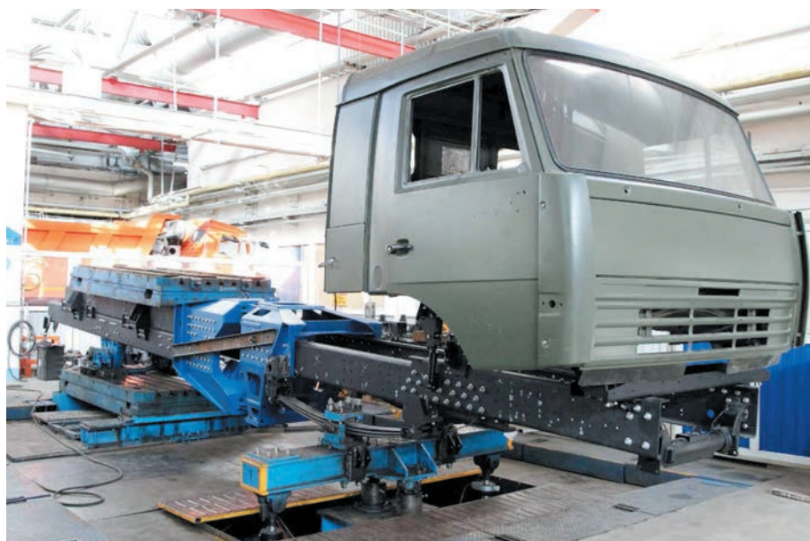
В основе «Арктики» стандартные элементы. Динамические испытания несущей системы
