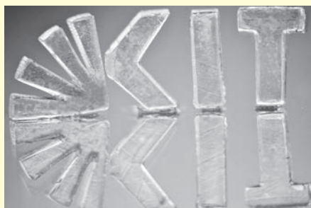
Пример напечатанной с помощью нового материала трёхмерной структуры: логотип Технологического института Карлсруэ. Фото из статьи в Nature
