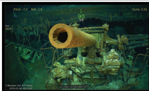
5-дюймовая пушка с сохранившейся нарезкой ствола
