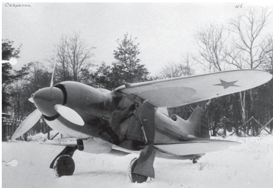
Конструктору Шевченко не удалось довести свой «складной истребитель» до серийного производства, но его идея воплотилась в крыле изменяемой геометрии уже в реактивную эру
