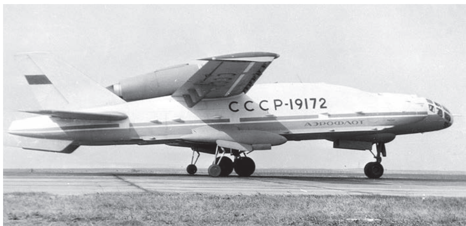
Экспериментальный самолёт 14МП-1 конструкции Р.Л.Бартини — прототип вертикально взлетающей амфибии ВВА-14, которая должна была обладать совершенно уникальными свойствами, но так и не пошла в серию
