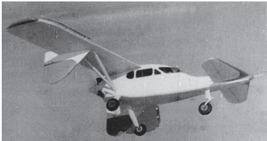
Экспериментальный самолёт МиГ-8 строился для исследований стреловидного крыла, но имел и другие оригинальные особенности — в расположении оперения, поверхностей управления и механизации
