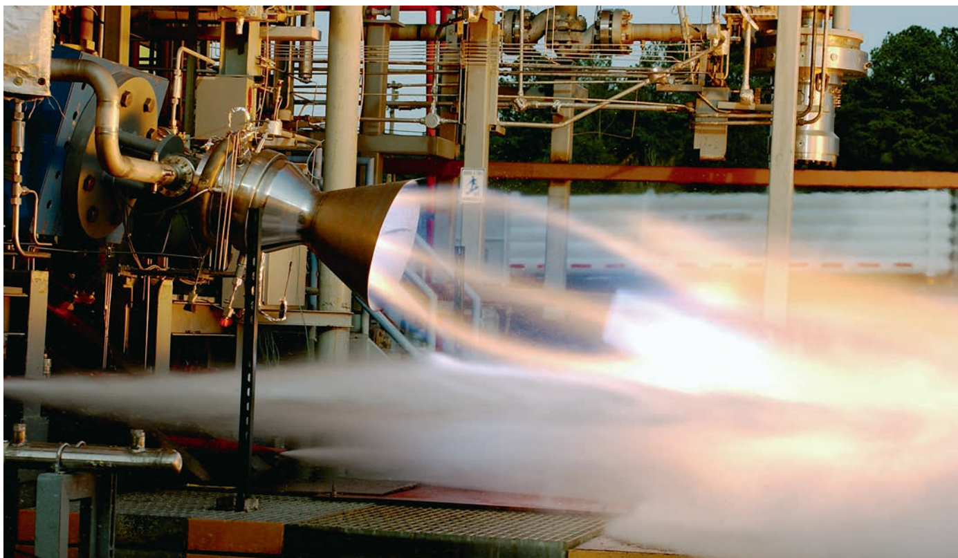
Американский двигатель RS-88 на этаноле и жидком кислороде
