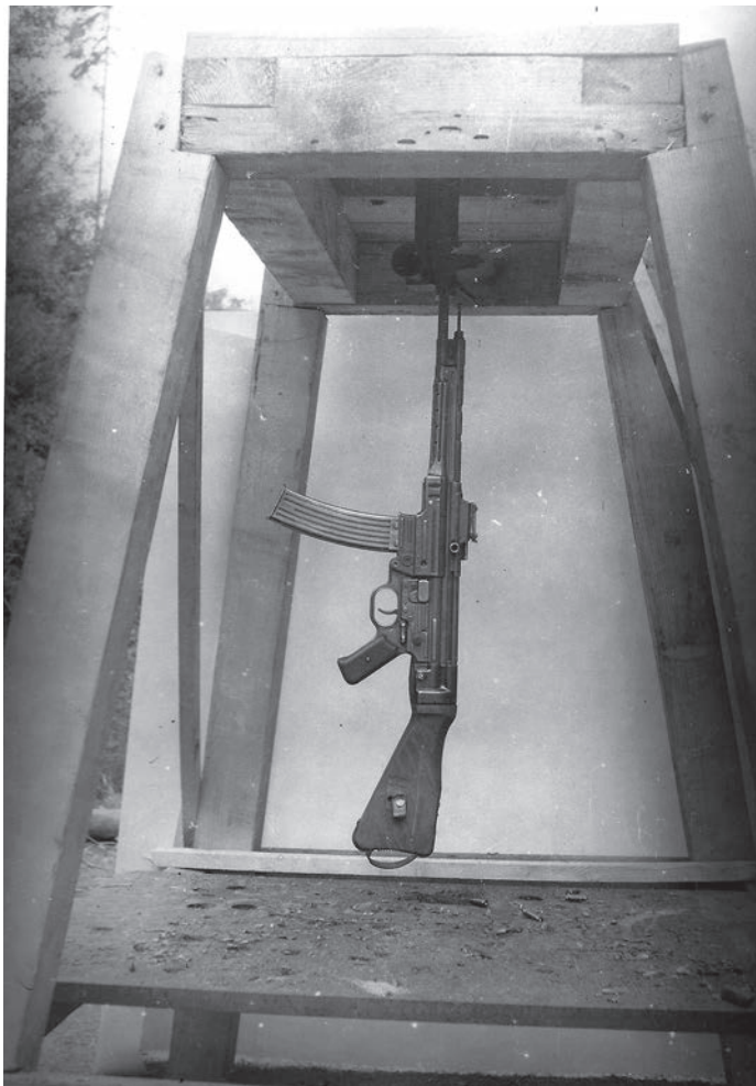
Так штурмовая винтовка StG 44 монтировалась на испытательном стенде с кривоствольным устройством фирмы «Хенель»
