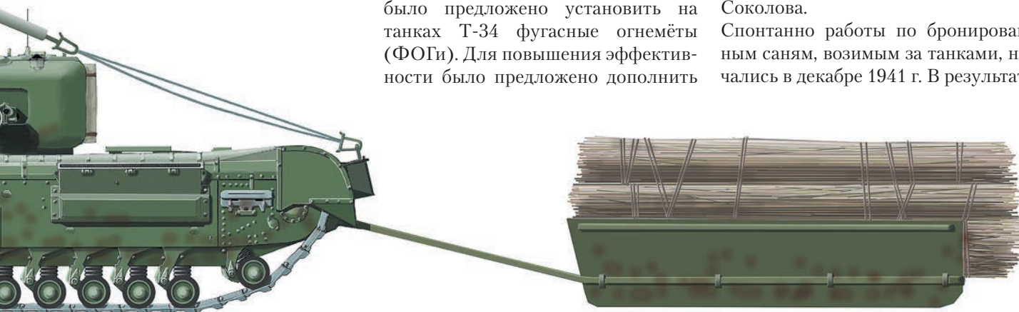
Сани и волокуши использовались в годы Второй мировой войны не только частями Красной армии. На рисунке английский инженерный танк Churchill AVRE, перевозящий в волокуше фашины
