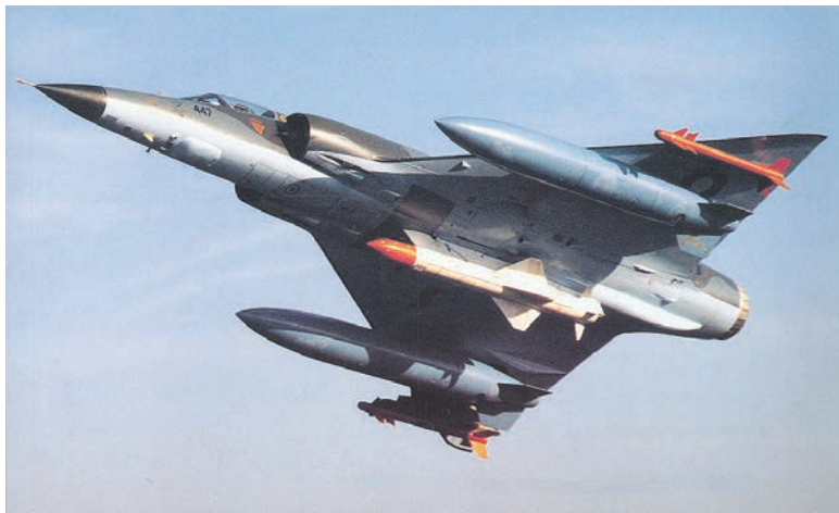
Истребитель-бомбардировщик «Мираж IIIС» со сверхзвуковыми подвесными баками и бетонобойной ракетой под фюзеляжем
