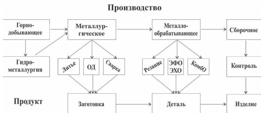
Рис. 1. Схема технологического маршрута машиностроительного производства. ОД — обработка давлением, ЭФО, ЭХО, Комбо — электрофизическая, электрохимическая, комбинированная обработка
