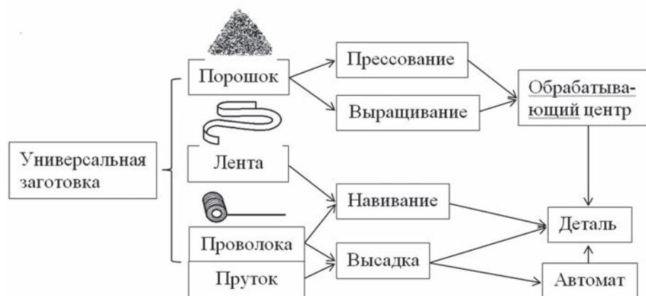
Рис. 4. Схема технологического процесса изготовления детали из универсальной заготовки
