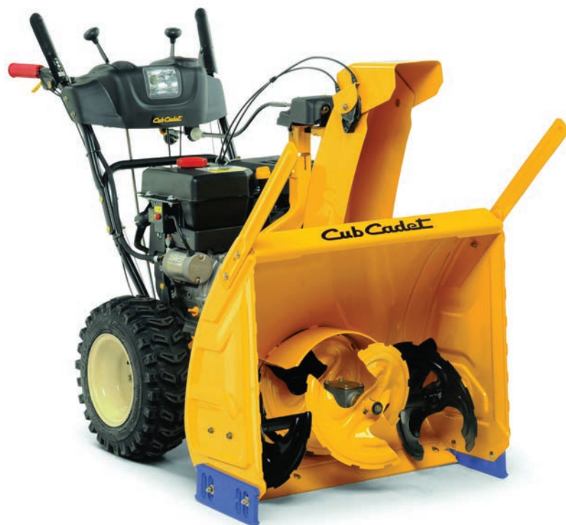
Возможен и более эффективный вариант с дополнительным шнеком на центральном валу
