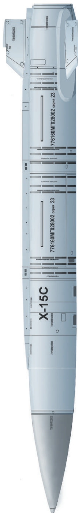
Аэробаллистическая ракета X-15 (изделие «115») с ядерной боевой частью (на разрыв подключения к носителю и на выходы газов ПАР установлены заглушки)
