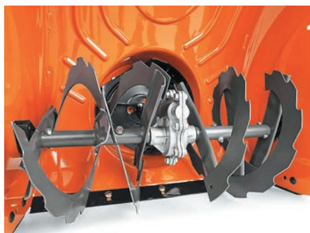
Классическая шнекороторная система: быстроходный центральный вал с крыльчаткой приводит в движение через червячный редуктор (в центре) два шнека
