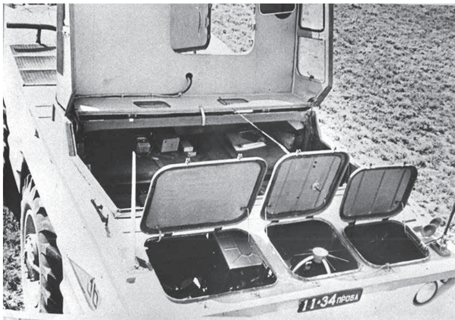
На доработанном образце пеленгатор разместили внутри носовой части внедорожника
