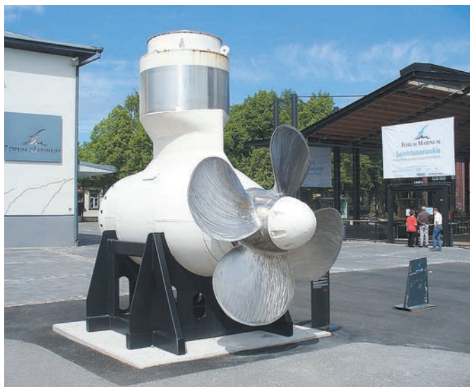
Рис. 5. Первый Azipod, установленный на буксире «Seilin» (морской музей г. Турку)
