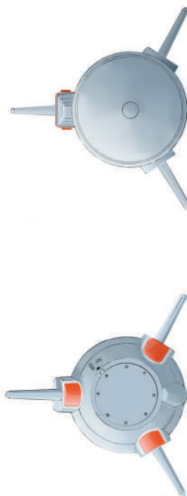
Аэробаллистическая ракета X-15 (изделие «115») с ядерной боевой частью (на разрыв подключения к носителю и на выходы газов ПАР установлены заглушки)
