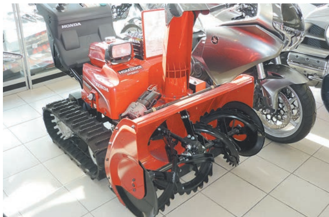
Тяжёлый гусеничный снегоуборщик Honda с электромеханической трансмиссией и его приборная панель
