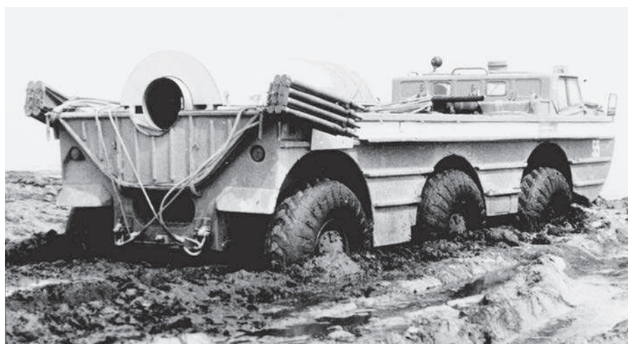
ПЗУ-1Р, оснащённая турбореактивным двигателем АИ-25ТЛ
