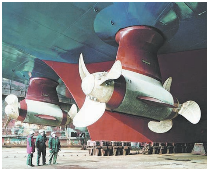
Рис. 4. Двухвинтовая ВРК с электродвигателем в гондоле типа Siemens-Schottel Propulsor (фото Siemens)
