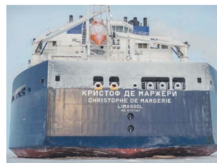
Рис. 9. Газовоз «Кристоф де Маржери» движется во льдах кормой вперёд
