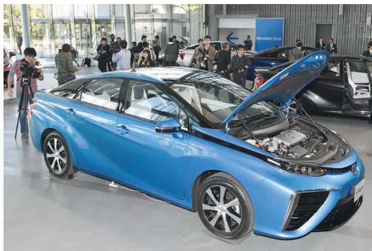
Toyota Mirai — первый в мире серийный автомобиль на водородных ячейках
