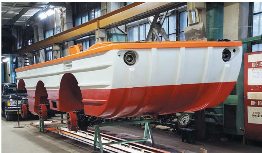
Корпус амфибии и многие другие элементы выполнены из стеклопластика
