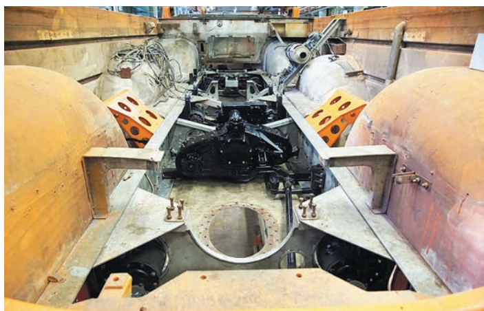
Машина имела несущую раму из алюминиевых сплавов
