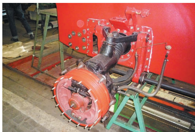
Передние и задние управляемые колёса снабдили независимой рычажно-торсионной подвеской
