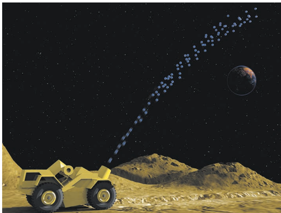
Рис. 4. Ровер с грунтометом формирует насыпи из реголита в качестве ловушек грузов, доставляемых методом жёсткой посадки.
