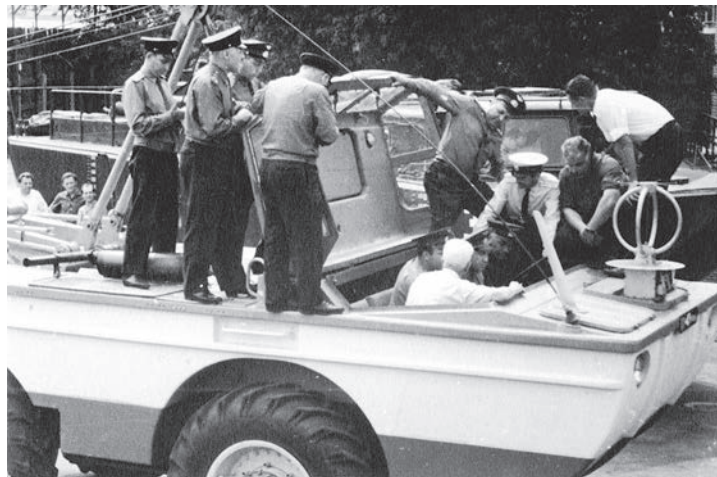
Колпак кабины сделали откидным, а на первых образцах пеленгатор находился на носовой части снаружи
