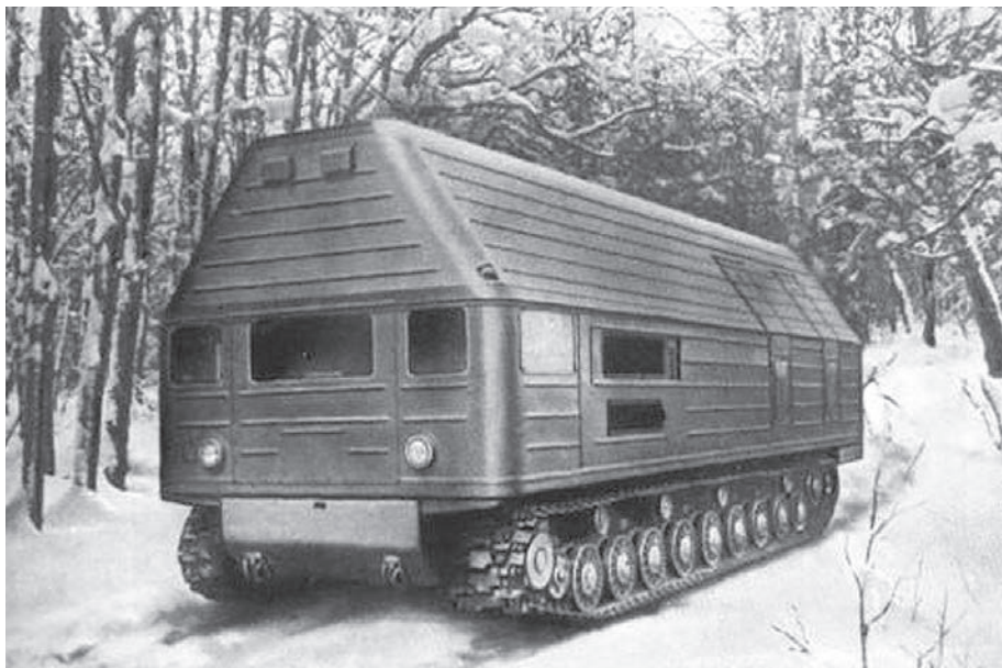
«Миниатюрные» атомные энергетические установки в СССР начали разрабатываться ещё более полвека назад. На фото — передвижная атомная электростанция ТЭС-3 на базе увеличенного шасси тяжёлого танка Т-10. Вся АЭС размещалась на четырёх таких машинах. Естественно, сегодня масса и габариты ядерных энергетических установок резко уменьшились
