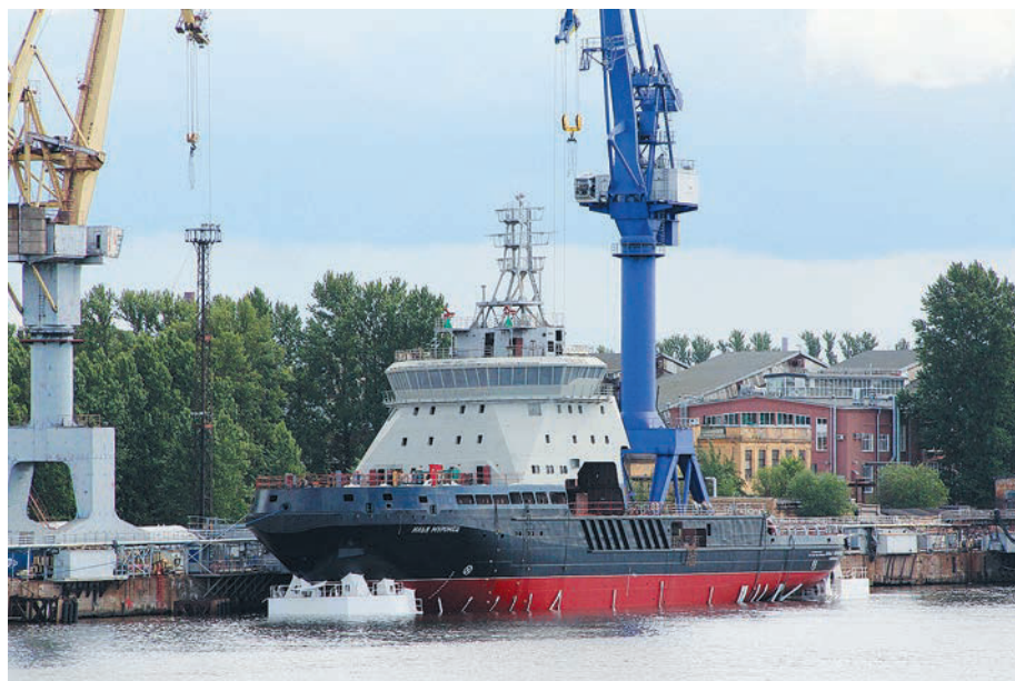
Спущенный на воду головной дизель-электрический ледокол обеспечения проекта 21180 «Илья Муромец», строящийся для ВМФ России, у докостроечной стенки АО «Адмиралтейские верфи». Санкт-Петербург, 10.06.2016
