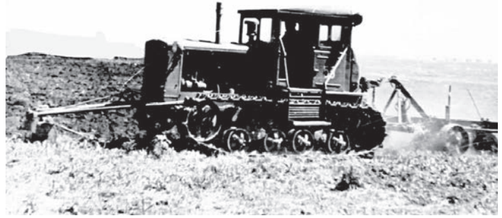
Испытания трактора в беспилотном режиме. Но с присутствием механизатора
