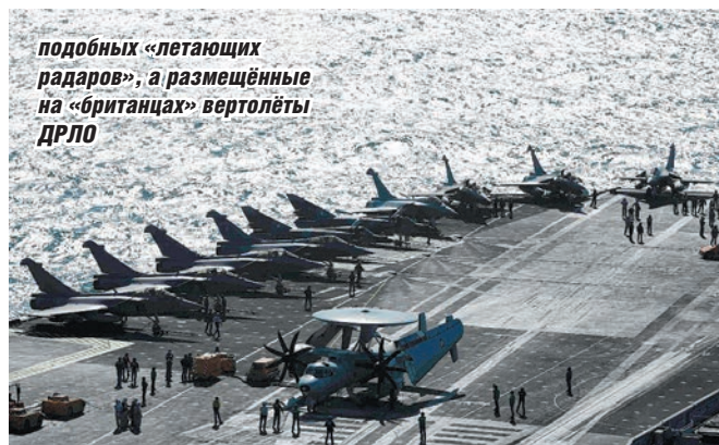
Французский атомный авианосец «Шарль де Голль» и его авиагруппа. Самолёты ДРЛО — значительно увеличивают боевые возможности авианосцев. Отсутствие катапульты сделало невозможным базирование на кораблях типа «Куин Элизабет»
