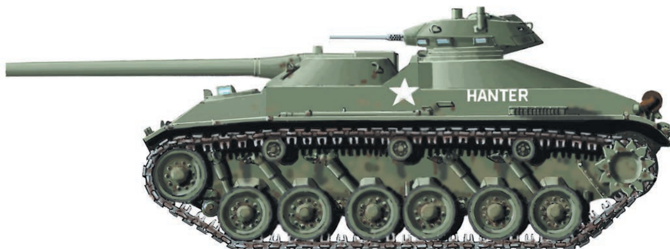
При внешней схожести с TV-1 тяжёлый американский танк «Хантер» имел традиционный двигатель, но необычную гидравлическую трансмиссию и многослойную броню
