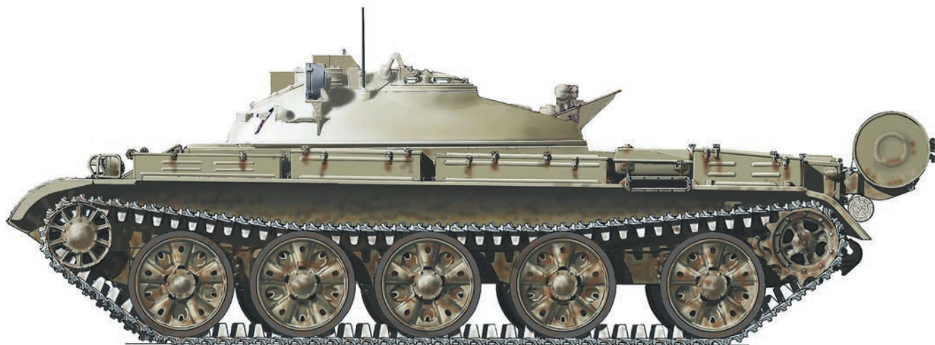
Советский ракетный танк ИТ-1 («объект 150») на базе среднего танка Т-62 — единственный серийный ракетный танк (состоял на вооружении Советской армии в 1968–1970 гг.). Главное оружие этой машины — ПТУР «Дракон»
