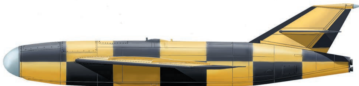
Крылатая ракета КСР первой опытной серии в окраске для кинографирования траектории полёта
