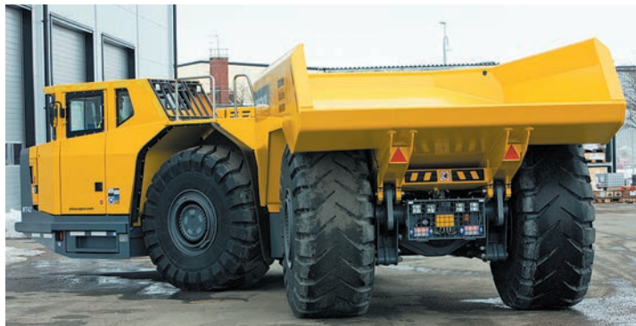
Манёвренность обеспечивает шарнирно-сочленённая схема
