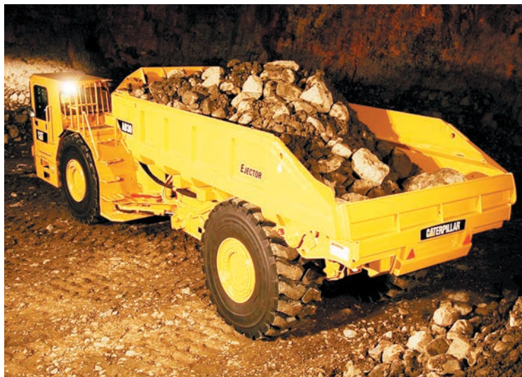
Самосвал Caterpillar AD 30 с разгрузкой кузова с помощью передвижного борта
