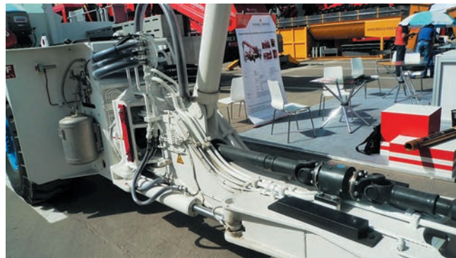
Узел сочленения грузовика и элементы трансмиссии
