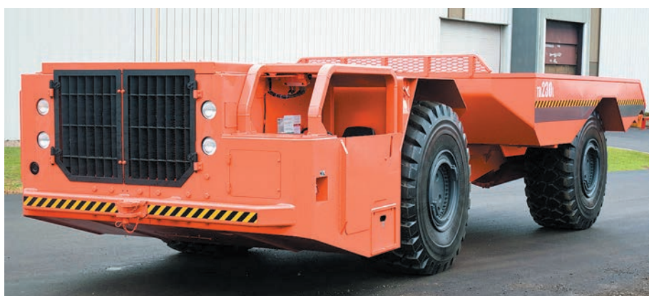
Подземные самосвалы отличаются супернизким профилем
