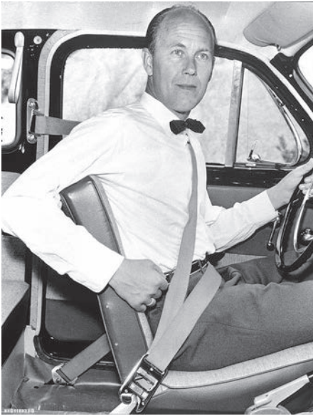
Нильс Болин (1920–2002) — шведский инженер, изобретатель трёхточечного ремня безопасности
