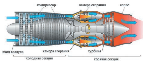
Схема течения газов в одноконтурном турбореактивном двигателе
