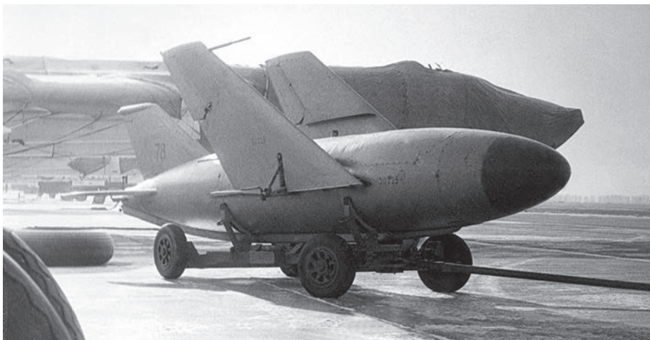
Ракета КСР-2 со сложенными в положение для хранения и транспортировки крыльями у носителя Ту-16
