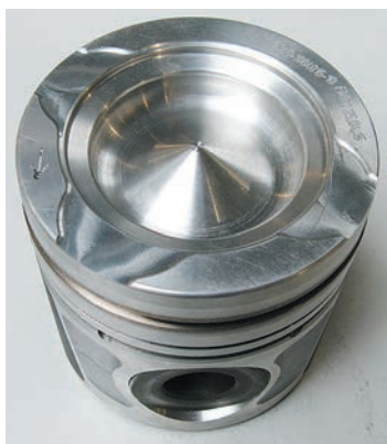
Поршень обеспечивает эффективность процесса сгорания
