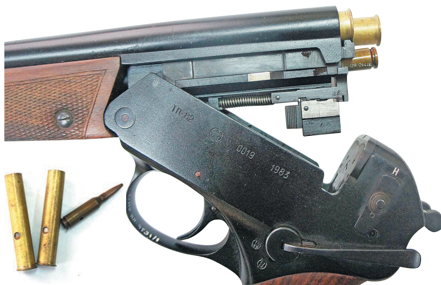
Патроны для ТП-82 — дробовые патроны СН-С, созданные в 1983 г. для гладких стволов, и 5,45-мм охотничий патрон СН-П для нарезного ствола. После открытия блока стволов пистолета ТП-82 экстрактор выдвигает из него патроны для удобства перезарядки или разрядки оружия
