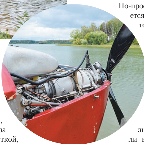
Это и есть турбостартёр ГТДЗ-117 для запуска мощных двигателей, превращённый в турбовинтовой двигатель для лёгкого самолёта
