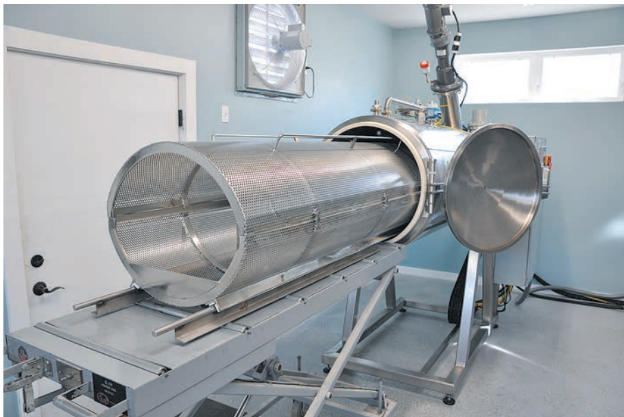
Камера для ресомации — щелочного гидролиза останков
