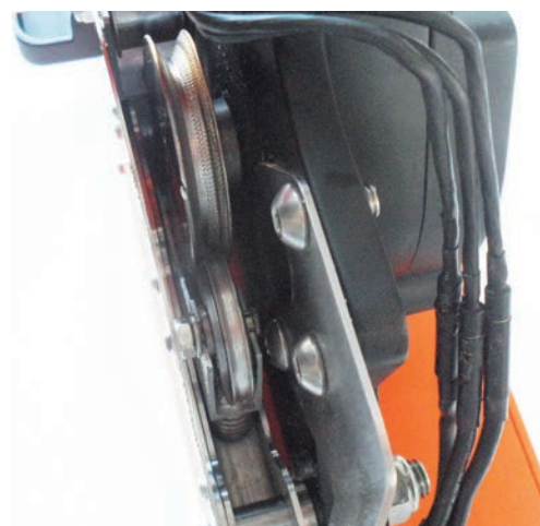
Для сцепления ручей приводного ролика выполнен с насечкой
