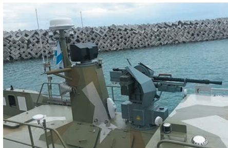
Боевой модуль «Управа-Корд» на головном катере проекта 03160
