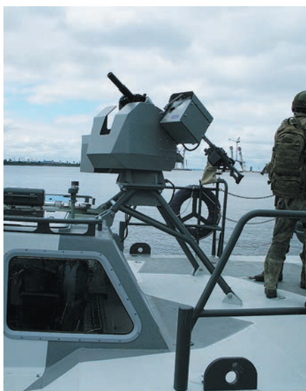
Боевой модуль МВДУ в гранатомётном варианте на борту БК-16
