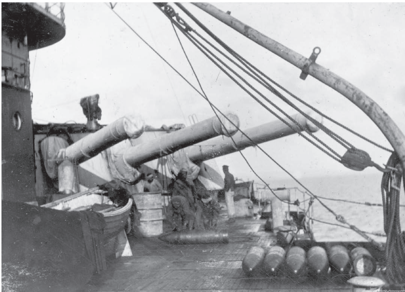
305-мм установка линкора «Генерал Алексеев» в Бизерте. Хорошо видно, в каком порядке хранились боеприпасы
