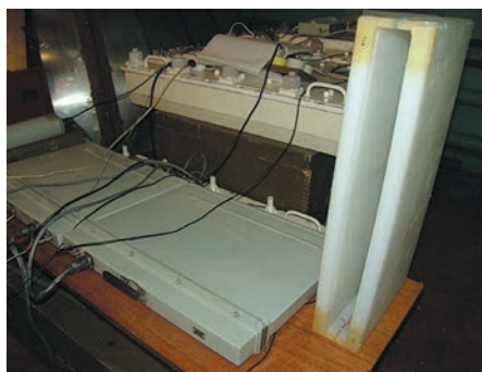
Мониторы (приборы для фиксации) тепловых нейтронов, исходящих из недр Земли
