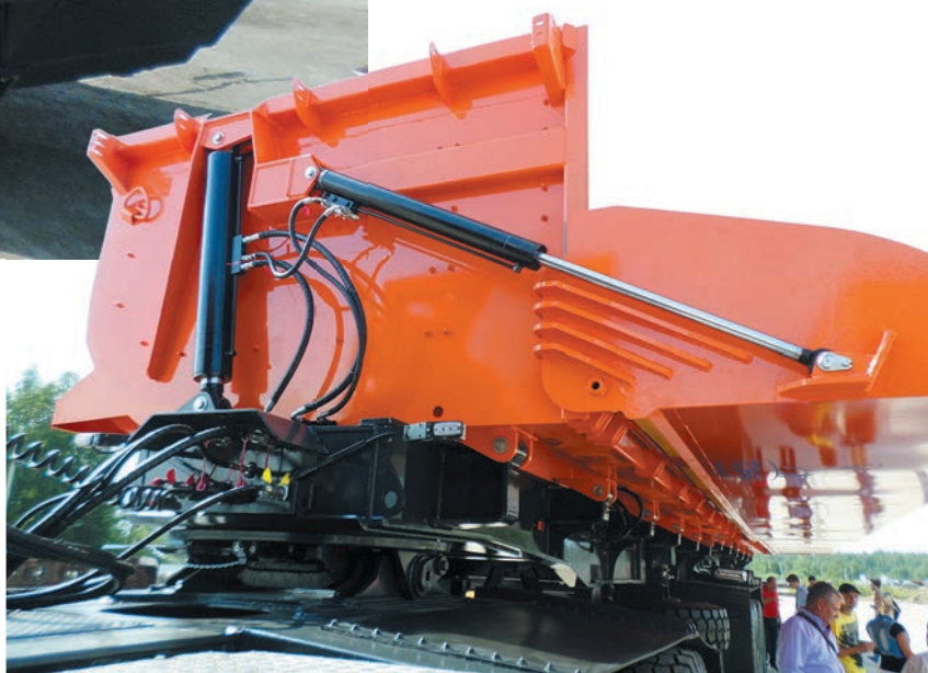
Один цилиндр открывает борт, другой — опрокидывает кузов
