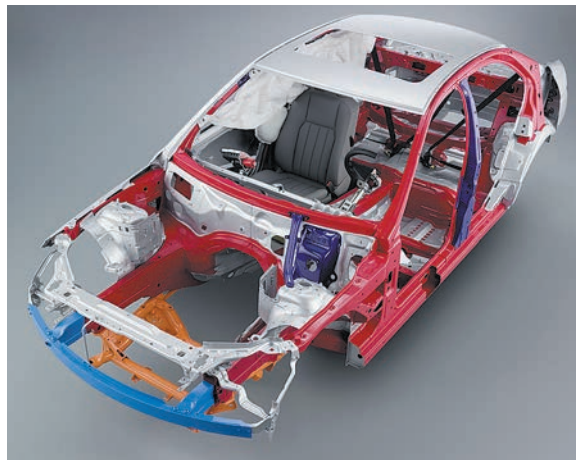
Основа современного кузова — высокопрочная сталь (выделено красным)
