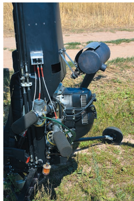
Коленвал 50-сильного мотора расположен вертикально...
