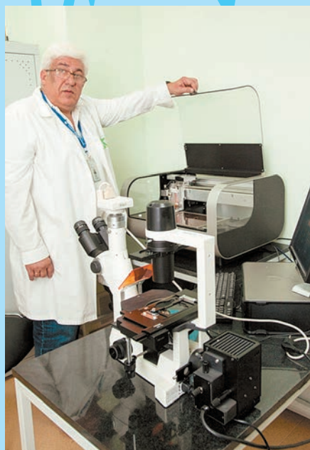
Комплекс для печати и анализа биodeградируемых матриц для тканевой инженерии. Комплекс состоит из 3D-принтера для пьезоэлектрической печати биологических объектов, управляющего компьютера и микроскопа для анализа морфологии полученных биологических структур
