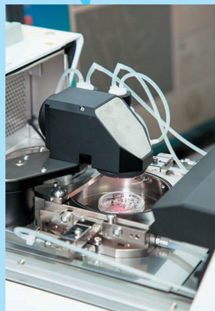
Биостанция NIKON IMQ для непрерывного культивирования клеток и фотосъёмки процесса в реальном времени
