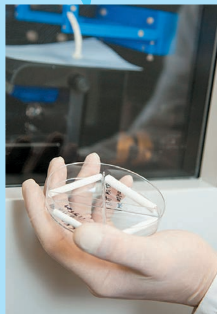
Металлический стержень, используемый в качестве подложки при формировании пористых трубок, которые могут служить матриксами при формировании тканеинженерных конструкций сосудов малого диаметра
