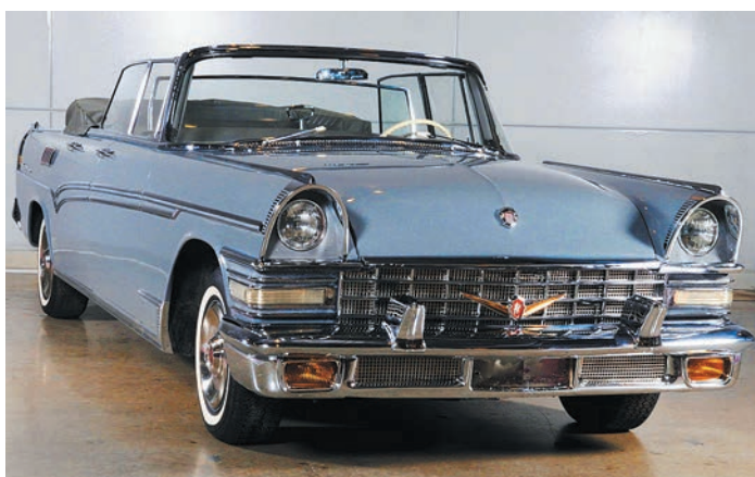
Парадный ЗИЛ-111В снабжался складным мягким верхом и четырьмя боковыми подъемными окнами в хромированных рамках
