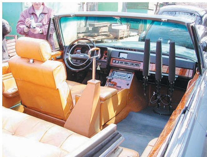
У машины отсутствует правое переднее сиденье, в салоне установлена тумба с поручнем, имеется также блок микрофонов
