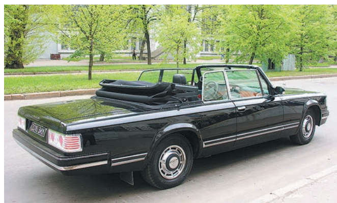
Открытый кузов с подъемными стеклами в рамках зиловцы сделали двухдверным
