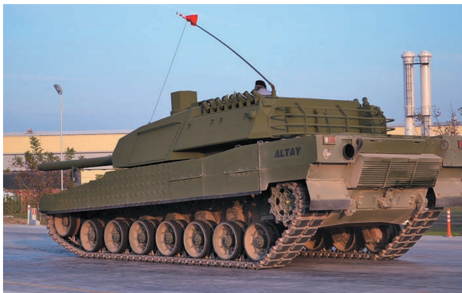
По семь опорных катков с каждого борта, бронерешётка выхода охлаждающего воздуха
