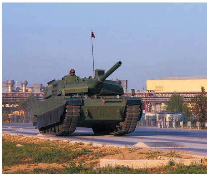
Обрезиненные гусеницы берегут дорожное полотно
