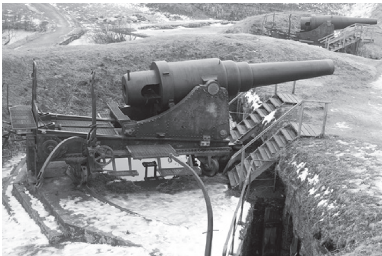
11-дюймовая пушка обр. 1867 г., установленная на лафете Дурляхера. Свеаборг, Финляндия
