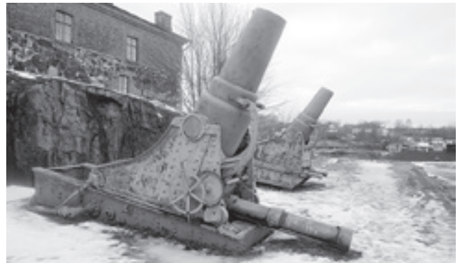
11-дюймовая мортира на станке Дурляхера. Свеаборг
