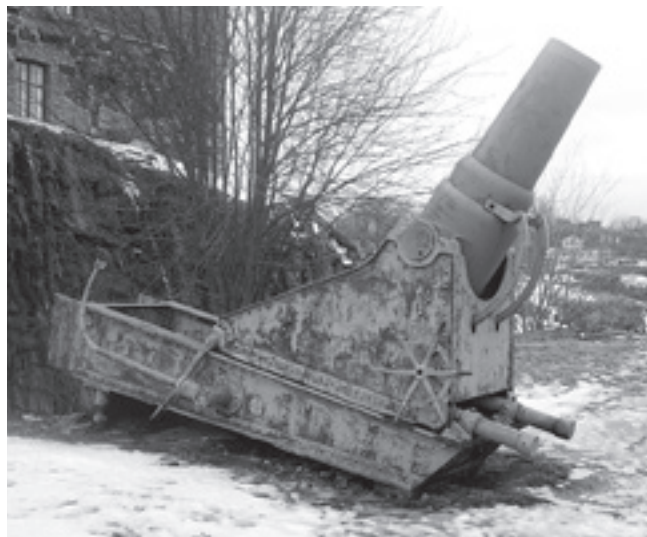
9-дюймовая мортира на станке Дурляхера. Свеаборг
