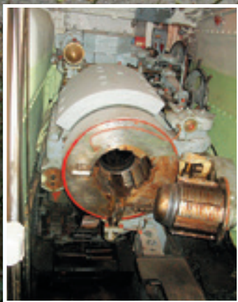
Казённая часть 305-мм орудия в башне батареи
