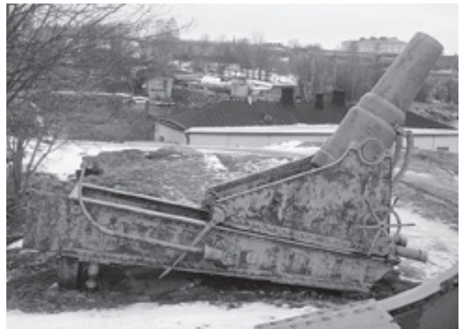
9-дюймовая мортира на станке Дурляхера. Свеаборг
